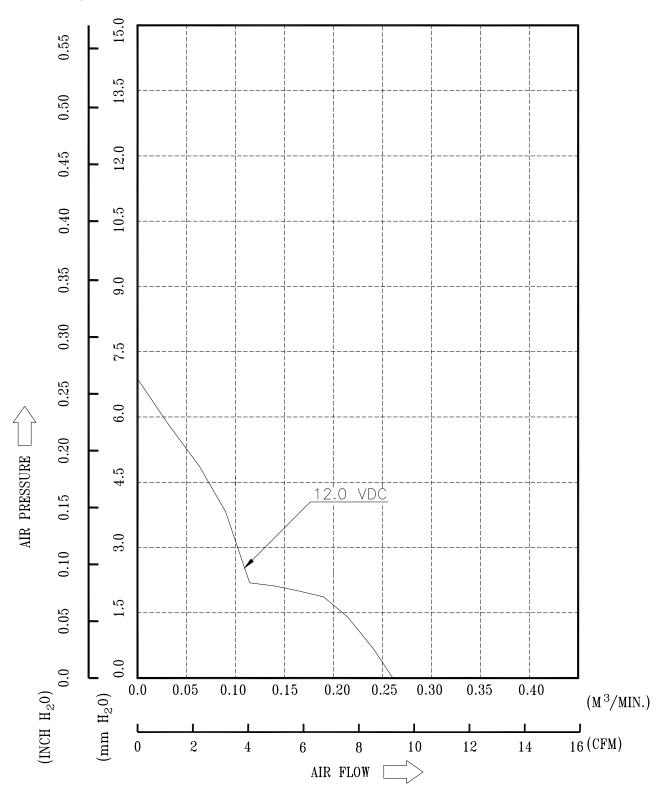
\* TEST CONDITION: INPUT VOLTAGE ----- OPERATION VOLTAGE TEMPERATURE ----- ROOM TEMPERATURE
