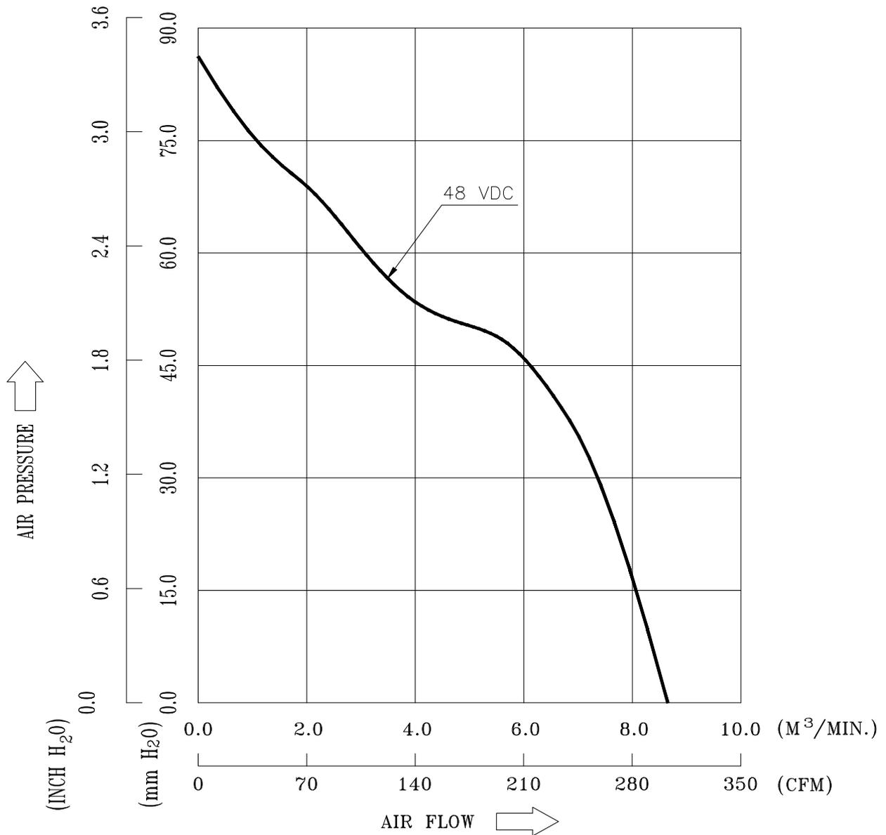
\* TEST CONDITION: INPUT VOLTAGE — OPERATION VOLTAGE
