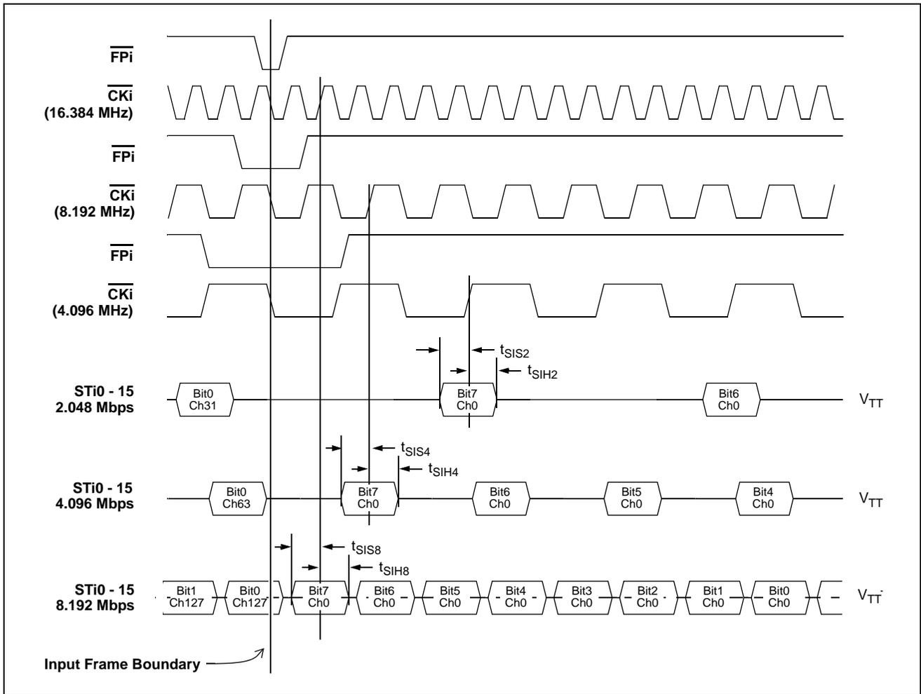
**Figure 44 - ST-BUS Inputs (STi0 - 15) Timing Diagram**
