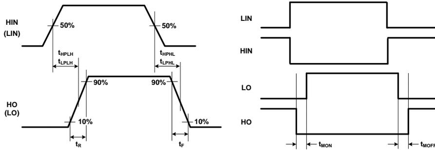
**Figure 23. Timing Diagrams**
