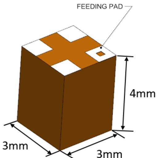
**FIGURE 2.3.1 DIMENSION OF THE 2.4GHZ CERAMIC ANTENNA**
