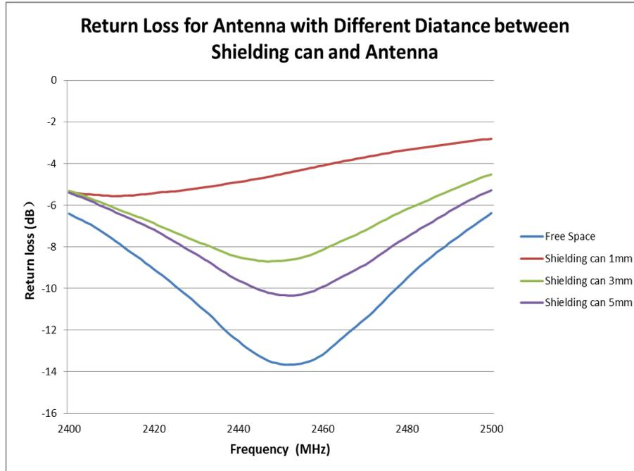
**FIGURE 7.1.2 RETURN LOSS COMPARISON AT 2.4 GHZ BAND OF SHIELDING CAN DISTANCE FROM ANTENNA**
