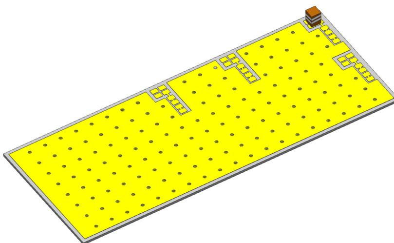
**FIGURE4.1.1 REFERENCE ANTENNA LOCATION**
