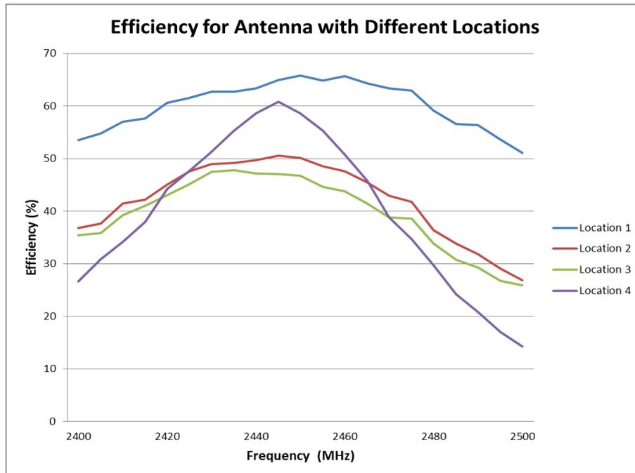
**FIGURE 7.3.3 EFFICIENCY COMPARISON AT 2.4 GHZ BAND AT FOUR LOCATIONS**
