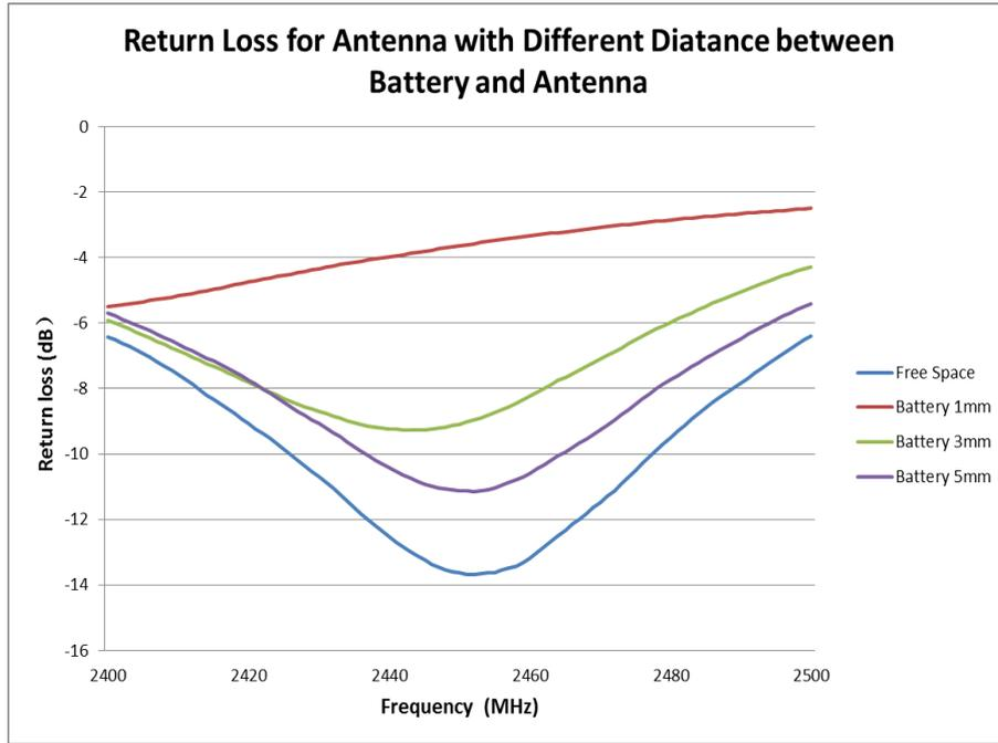
**FIGURE 7.2.2 RETURN LOSS COMPARISON AT 2.4 GHZ BAND OF BATTERY DISTANCE FROM ANTENNA**
