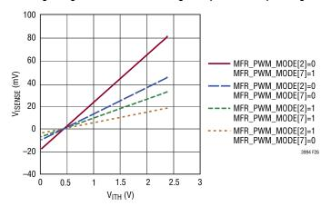
Figure 26. V<sub>ITH</sub> vs V<sub>ISENSE</sub>
